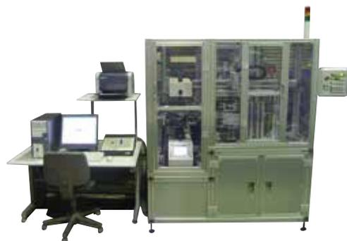
全自動ビッカース硬さ試験システム
