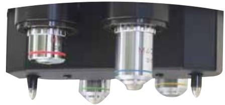
従来の安定した荷重軸機構を踏襲しながら2本圧子、4本対物レンズ構造を実現。様々な試験条件において信頼性の高い試験を行うことができます。(全機種対応)
