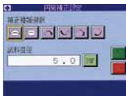
球面・円筒の試験時の補正を設定できます。
