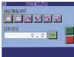
球面・円筒の試験時の補正を設定できます。
