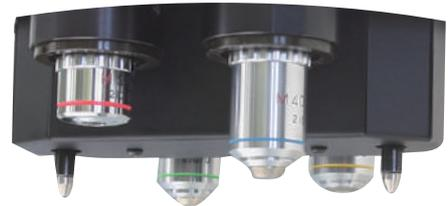
従来の安定した荷重軸機構を踏襲しながら2本圧子、4本対物レンズ構造を実現。様々な試験条件において信頼性の高い試験を行うことができます。(全機種対応)
