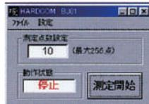
接続方法: 硬さ試験機出力(RS232C)—PC入力(RS232CまたはUSB)
