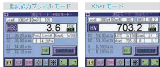
鋼球圧子(オプション)を取り付け、試験力の合うブリネル硬さを試験可能です。
